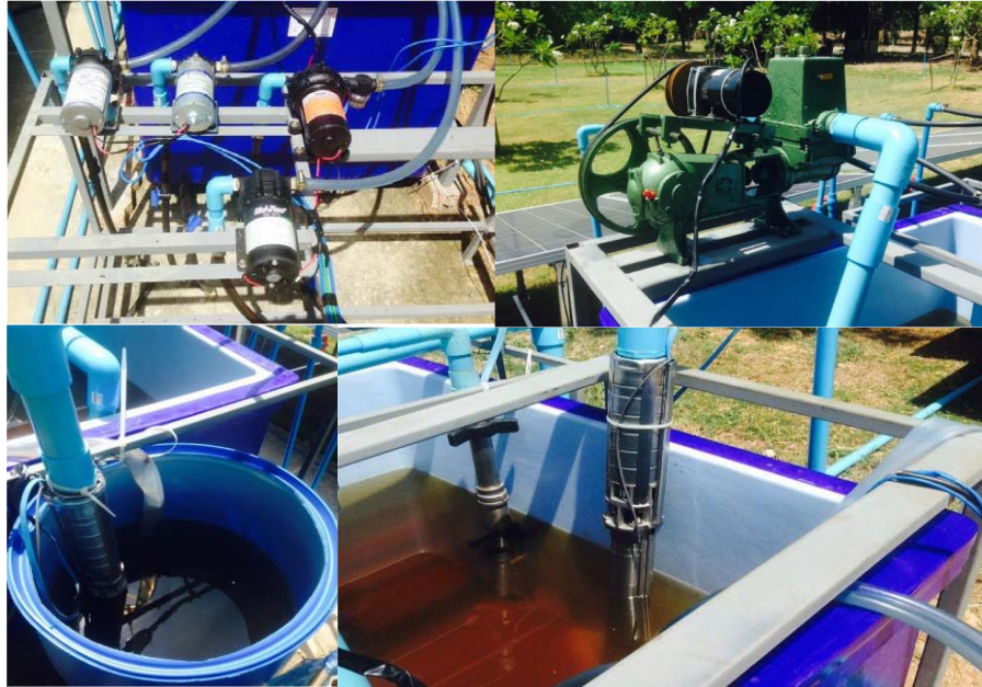
รูปที่ 4 ปัมป์สูบน้ำพลังงานแสงอาทิตย์
